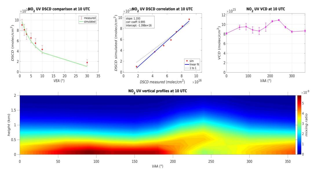
plena operatividad del instrumento está permitiendo obtener los espectros que proporcionan información sobre el perfil vertical de la concentración de gases traza y sobre la dinámica de transporte de la contaminación alrededor de la zona de observaciones, lo que posibilitará la investigación climática y la mejora de la calidad del aire en la ciudad de Madrid. La figura muestra la distribución vertical de NO2 en la región UV a las 10:00 UTC del día 27 de junio, junto con las DSCDs y VCDs
