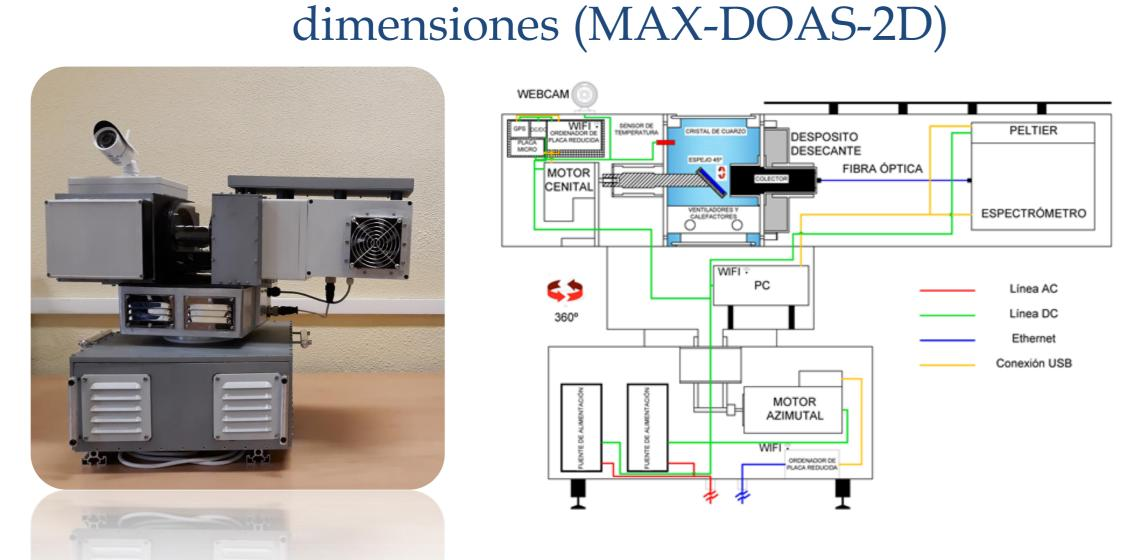
Se ha diseñado y construido un instrumento MAX-DOAS-2D que escanea la atmósfera 90° en la dirección vertical (zénit) y 360° en la dirección horizontal (acimutal). Con una resolución temporal de 1 hora, este instrumento proporciona información sobre el perfil vertical de la concentración de gases traza y sobre la dinámica de transporte de la contaminación dentro y alrededor de Madrid.
